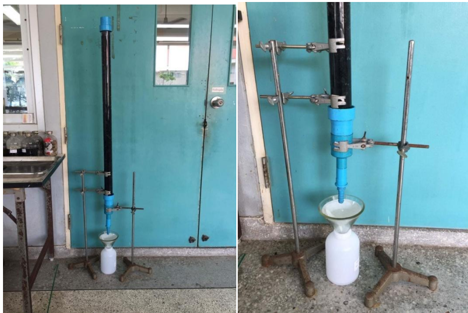
ภาพประกอบ 34 การทดสอบการกรองตัวอย่างน้ำจากชุมชนบางเขียดโดยใช้ถ่านกัมมันต์เงื่อนไขกรด ฟอสฟอริก 85% เวลากระตุ้น 6 ชั่วโมง อัตราส่วนถ่าน : กรด เท่ากับ 1 : 3
