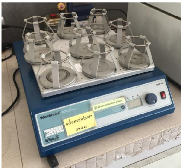
ภาพประกอบ 31 เครื่องเขย่าในแนวนอน ยี่ห้อ WiseShake รุ่น SHO-2D
