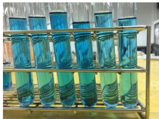
ภาพประกอบ 33 การทดสอบประสิทธิภาพในการดูดซับเมทิลีนบลูของถ่านตัวอย่าง
