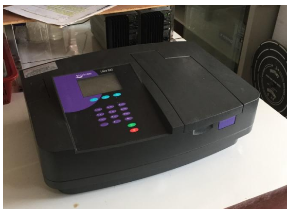
ภาพประกอบ 30 เครื่องยูวีวิชีเบลสเปคโตรโฟมิเตอร์ ยี่ห้อ biochrom รุ่น Libra S22
