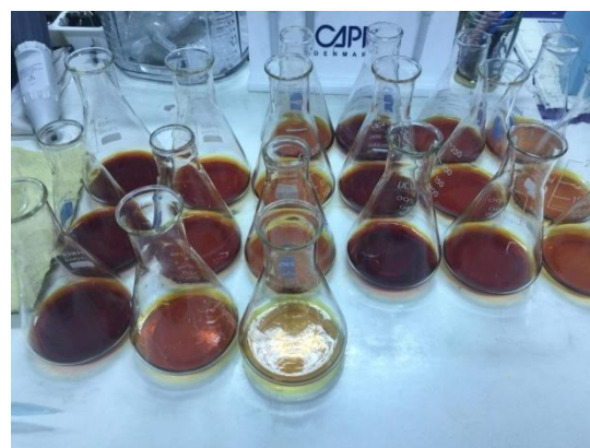
ภาพประกอบ 32 การทดสอบประสิทธิภาพในการดูดซับไอโอดีนของถ่านตัวอย่าง
