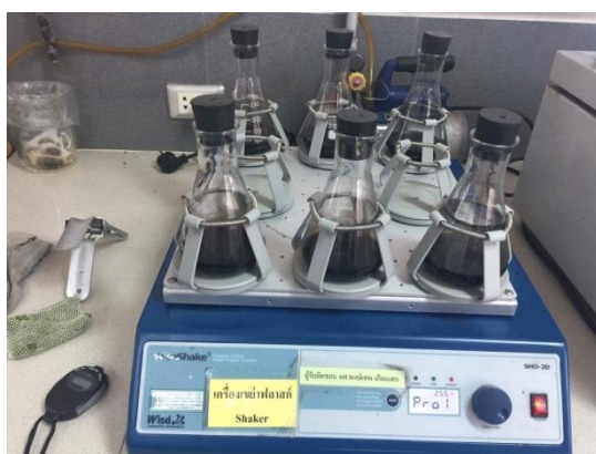
ภาพประกอบ 32 การทดสอบประสิทธิภาพในการดูดซับไอโอดีนของถ่านตัวอย่าง
