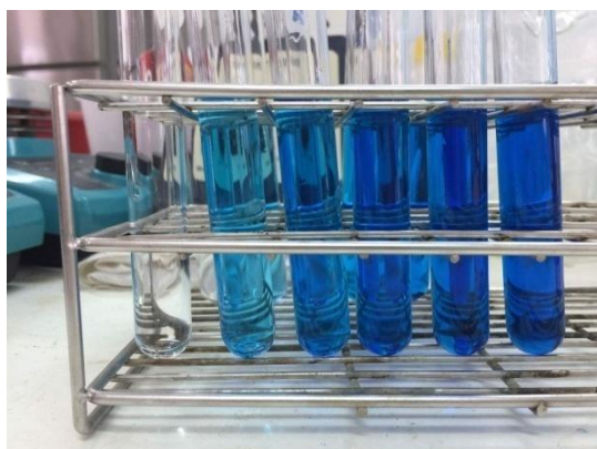
ภาพประกอบ 33 การทดสอบประสิทธิภาพในการดูดซับเมทิลีนบลูของถ่านตัวอย่าง
